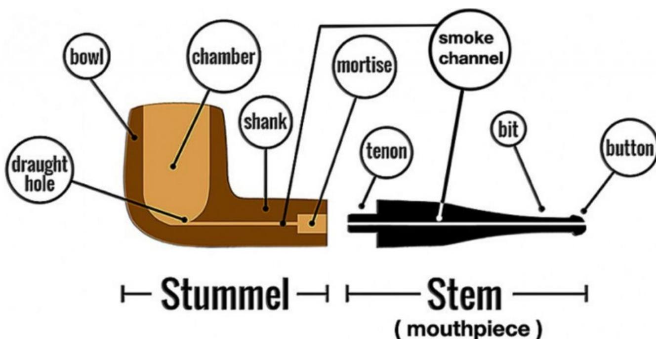
A mecânica, ou engenharia, de um bom cachimbo é tudo sobre o que não está lá. A *tobacco chamber*, *draft hole*, *smoke channel and slot* \*(mantém-se os nomes em inglês para clareza da imagem) determinam as qualidades de fumar de um cachimbo.
